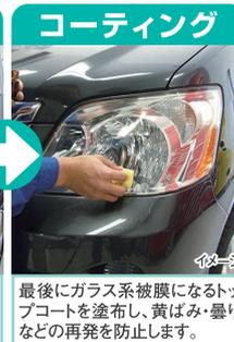
最後にガラス系被膜になるトップコートを塗布し、黄ばみ・曇りなどの再発を防止します。
