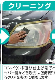
コンパウンド及び仕上げ剤でペーパー傷などを除去し、透明感あるクリアな表面に調整します。
